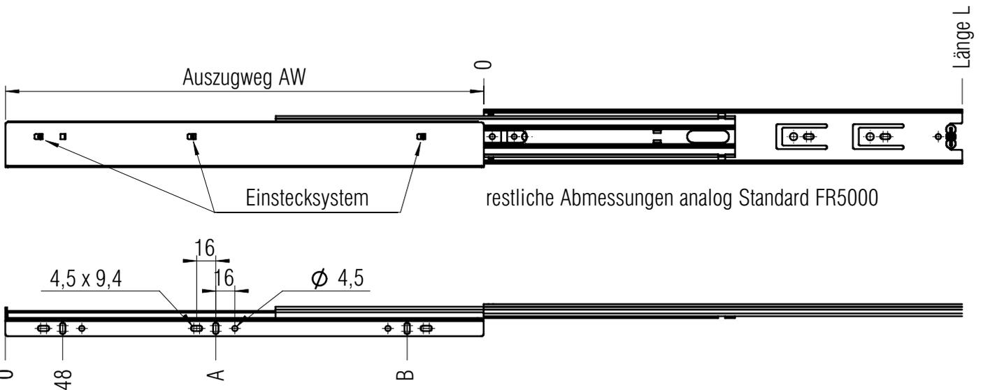
Anschraubbohrungen für 3,5 mm Spax-Schraube
